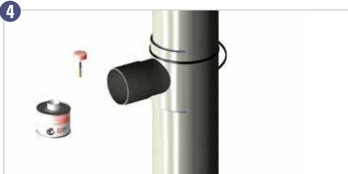
4 Encolar el tubo y la boca injertada, unir y luego sujetar firmemente.
