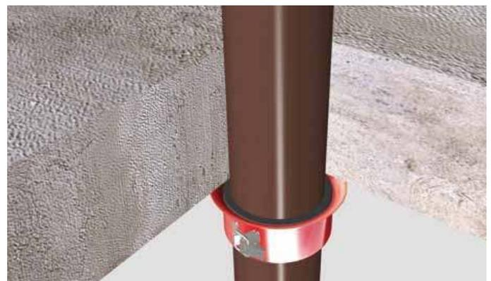
2. En las instalaciones en forjados, requiere el montaje de un solo manguito en la cara inferior de dicho forjado.
